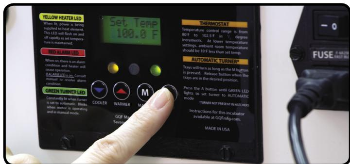
3. Appuyez sur le bouton "A" pour désactiver le mode automatique et permettre au bouton "M" de fonctionner. Nivelez les tiroirs dans l'incubateur en utilisant les commandes de l'écran de contrôle. Appuyez sur le bouton blanc M et maintenez-le enfoncé jusqu'à ce que les tiroirs se placent au niveau puis relâchez-le. Les racks peuvent maintenant être accédés. Appuyez sur le bouton jaune A pour ramener l'incubateur en mode de retournement automatique.
